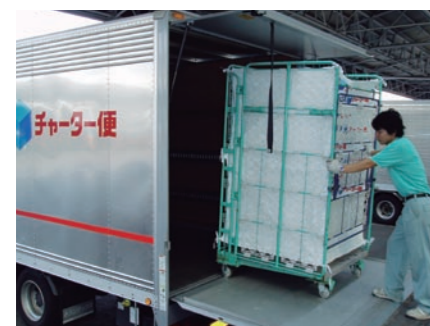
「JITBOXチャーター便」は、四方を頑丈な柵で覆われた縦横約1メートル・高さ1.7メートルの貨物輸送用コンテナで、底部に移動用のキャスターがついたRBP1本から貸切輸送サービスを提供。複数の納品先に同時に届けるなど、顧客企業の細かいニーズに応じたサービスを実現している。
