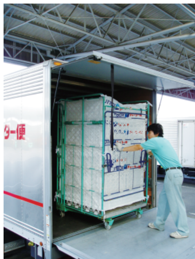
宅急便の幹線輸送に利用されていたロールボックスパレット (内寸104cm×104cm×170cm) がJITBOXチャーター便の単位。取り扱い容易なことから、利用者のみならずフランチャイズ参加の輸送事業者からも好評価を得ている。
